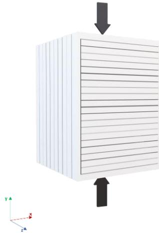
*Figura 3-3 Representação esquemática da direcção de aplicação da carga num ensaio de compressão uniaxial de um provetes impresso com ângulo de deposição de 90° (os ângulos de deposição mencionados neste trabalho têm como referência a direcção de aplicação da carga)*
