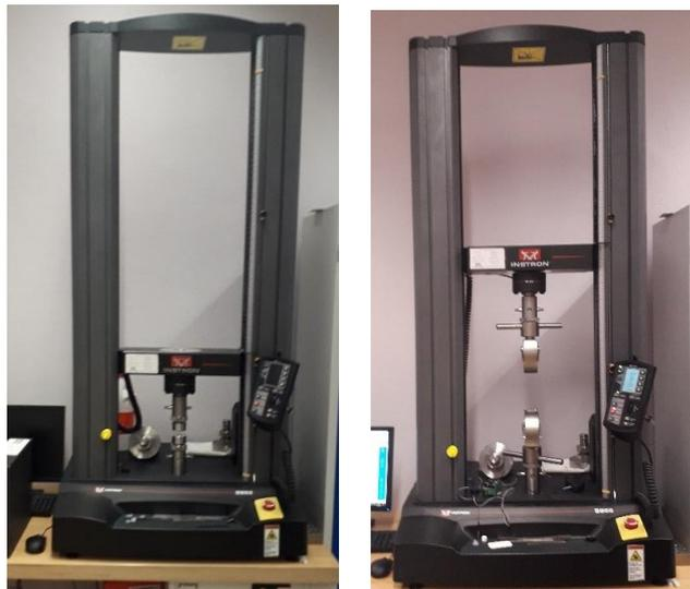
Figura 3-10 Instron 5966 utilizada nos ensaios de caracterização mecânica com acessórios para realizar os ensaios de compressão uniaxial (esquerda) e de tracção uniaxial (direita)
