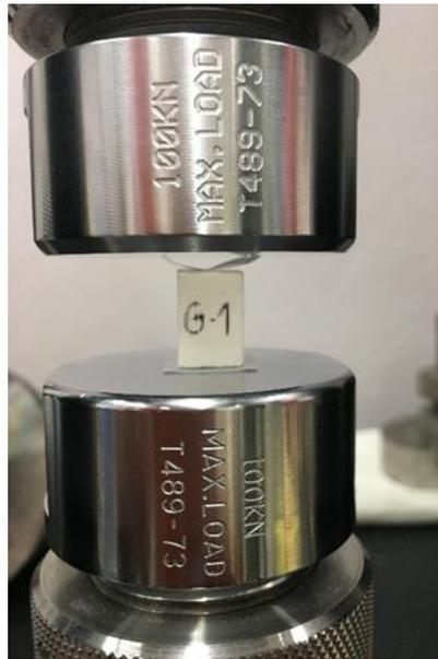
Figura 3-17 Ensaio de compressão com fita de teflon na interface entre o provete e os pratos compressores
