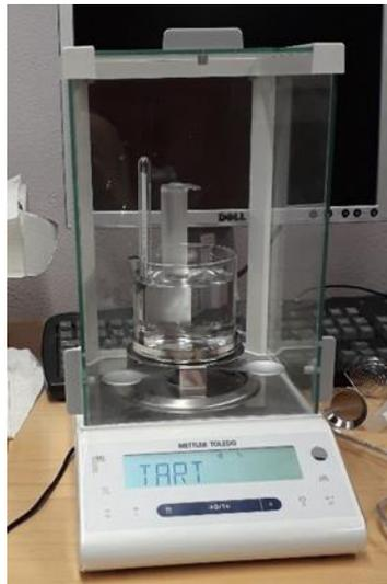
*Figura 3-11 Balança de precisão Mettler Toledo ML204*
